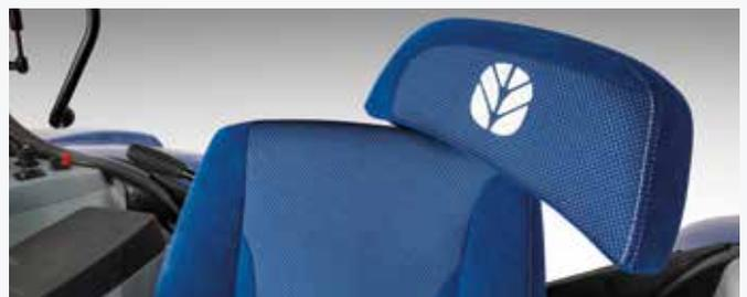
Sowohl die Dynamic Comfort™- als auch die Comfort-Sitze verfügen über eine neue ausziehbare Rückenlehne, die der oberen Rückenpartie zusätzlichen Halt gibt und den Komfort erheblich verbessert, wenn der Sitz zum Kontrollieren der Heckanbaugeräte gedreht wird.
