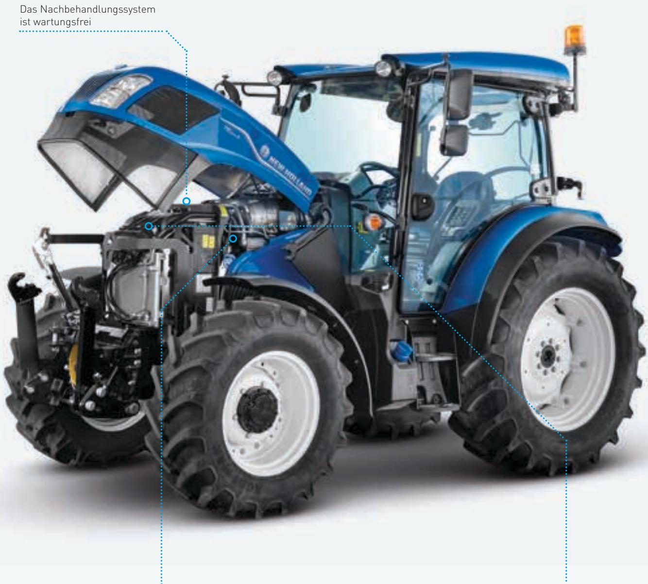
Alle Wartungsarbeiten können von einer Traktorseite aus ausgeführt werden. Die Wartungspunkte sind zugangsfreundlich auf der linken Seite angeordnet
