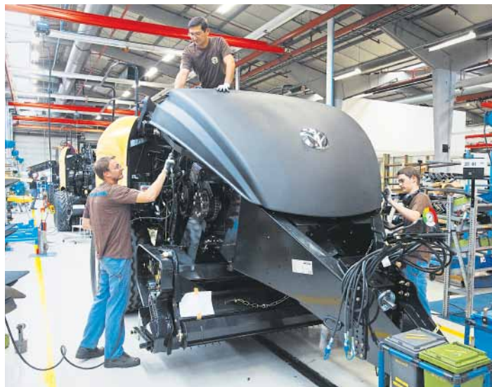
In Zedelgem werden auch die BigBaler-Großpackenpressen produziert. Sie pressen Ballen von 80 x 70 cm bis 120 x 90 cm.
